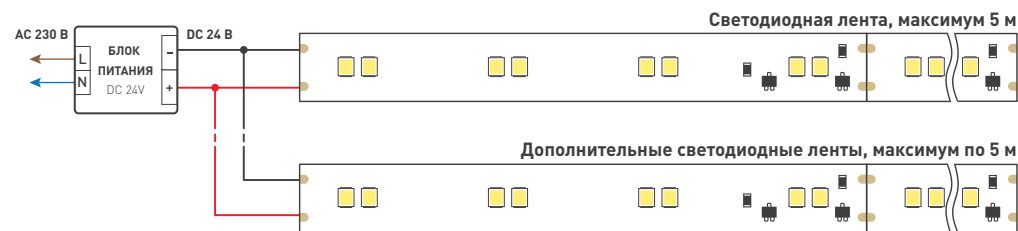
Схема 1. Подключение нескольких светодиодных лент с двух сторон
