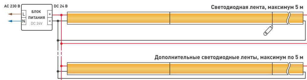
Рис. 1. Подключение нескольких светодиодных лент с двух сторон
