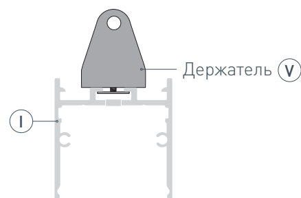
Рис. 1. Установка держателя в паз профиля. Вид сбоку
