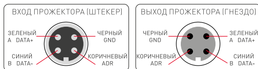
Цоколевка коннекторов на сигнальных кабелях
