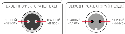
Цоколевка коннекторов на кабелях питания
