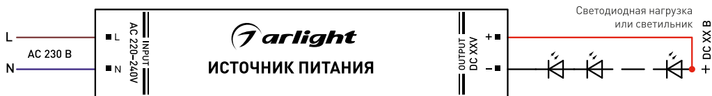
Рис. 1. Пример подключения источника питания
