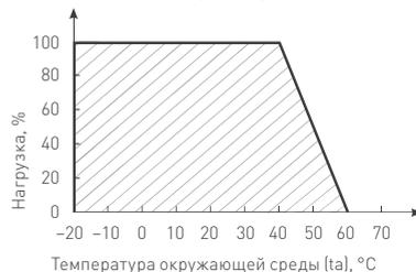
Рис. 7. Максимальная допустимая нагрузка, % от мощности источника
