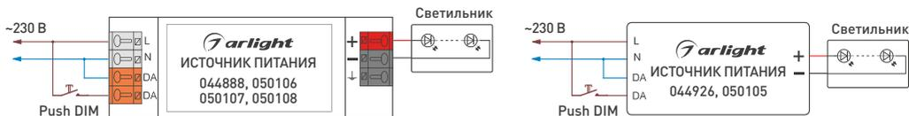
Рис. 3. Подключения источника питания с управлением Push DIM
