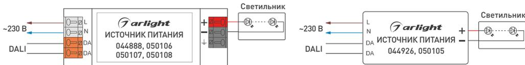
Рис. 2. Подключения источника питания с управлением DALI
